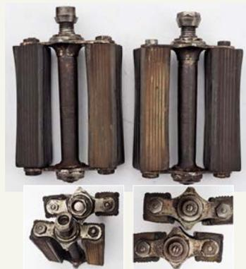
Pedale von Dürkopp, für Damenrad um 1898, zur Befestigung mit Konusmutter (1 St. Konusmutter ersetzt), extrem selten, guter Zustand
