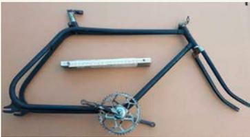
Messemodell eines Rahmens, der ohne Sattelrohr auskommt, 1930er Jahre Neukonstruktion des Rohrsatzfabrikanten BENTLER, damals in Bielefeld. Aufwändig gefertigtes Tischmodell
