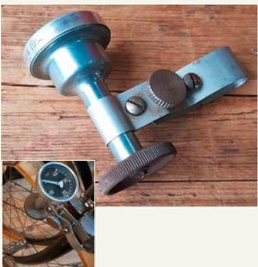
Ennwell Radläufer-Tachometer, zur Montage an der Gabelscheide, wohl um 1950, alte Neuware
