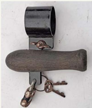
Luftpumpen-Rahmenschluss, wobei der Luftpumpengriff zugesperrt wird, mit originalem Schloss, seltenes Zubehör für den vorsichtigen Radfahrer
