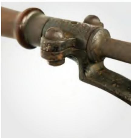
Drehbarer Lenker mit Bündchen und Ölloch
