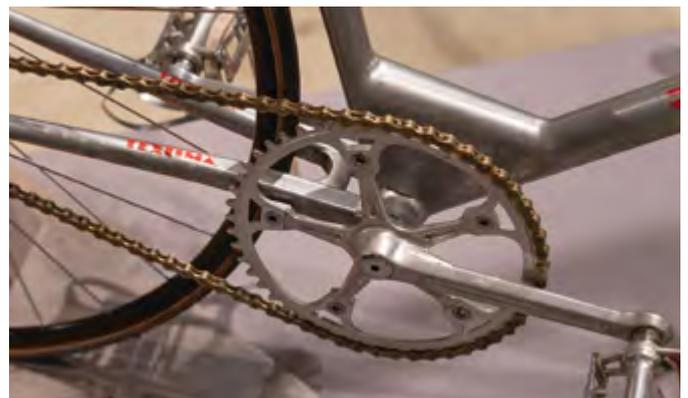
Bahnrenner von 1989: verstärkter Tretlagerbereich, vierkantige Kettenstrebe, befeilte Campa-Kurbeln
