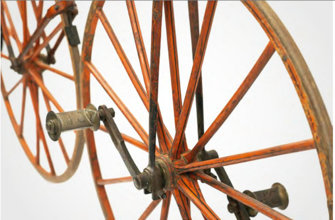
Die hohlen Pedale mit Firmeninitialen und das Lager mit der gekonterten Spannmutter
