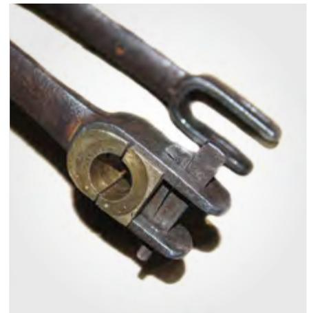
Die Lagerblöcke und Keile bei einem anderen Hersteller, Position der Keile vertauscht
