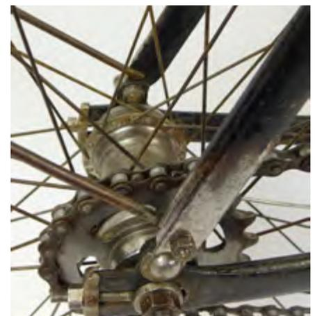
*Markentypische Verschraubung der hinteren Schutzblechstrebe*
