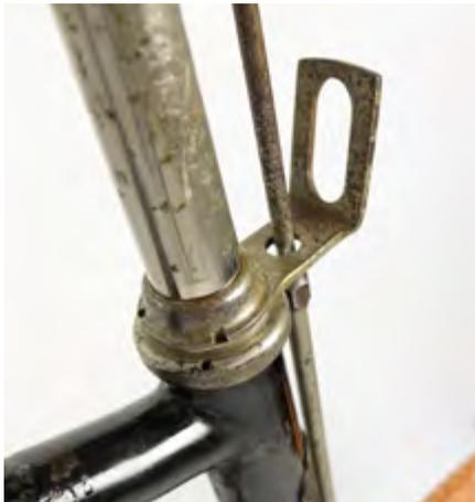
Der Lampenhalter mit der engen Durchführung für das Bremsgestänge
