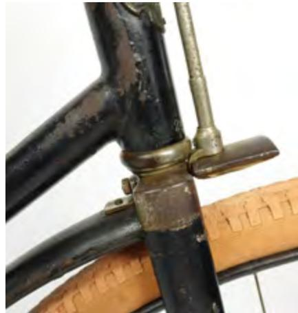
Einfach gefertigter vorderer Schutzblechhalter, Bremsgestänge mit innenliegender Feder
