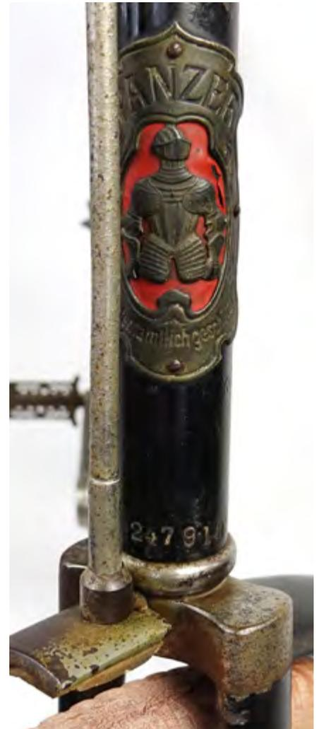
Bremsgestänge mit Sechskantmutter, Rahmennummer über der unteren Lagerschale
