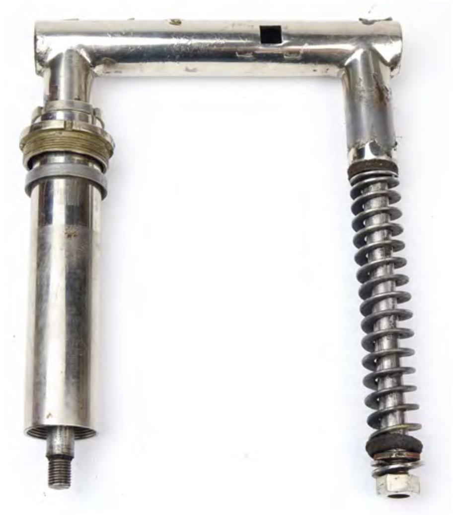
Rechts: Innenleben der Federpatrone. Links: der Gewinding über der Federpatrone drückt den darunterliegenden Sicherungsring gegen das Federblech in der Rahmenmuffe
