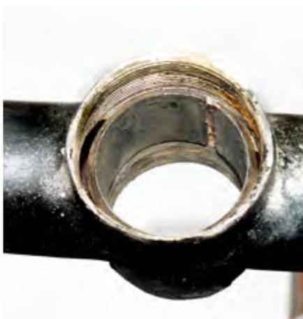
Nach außen abgeschrägtes Federblech in der Oberrohrmuffe
