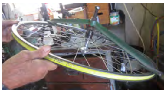
Boesch's selbstgebaute Zentrierlehre
