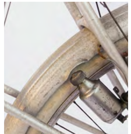
Schutzblechausbuchtung für den Dynamo, Scheuerschutz an der Elektrokabeldurchführung
