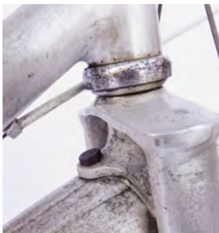
Schutzblechbefestigung, Gewebezwisehenlage verhindert das Klappern der Schutzbleche
