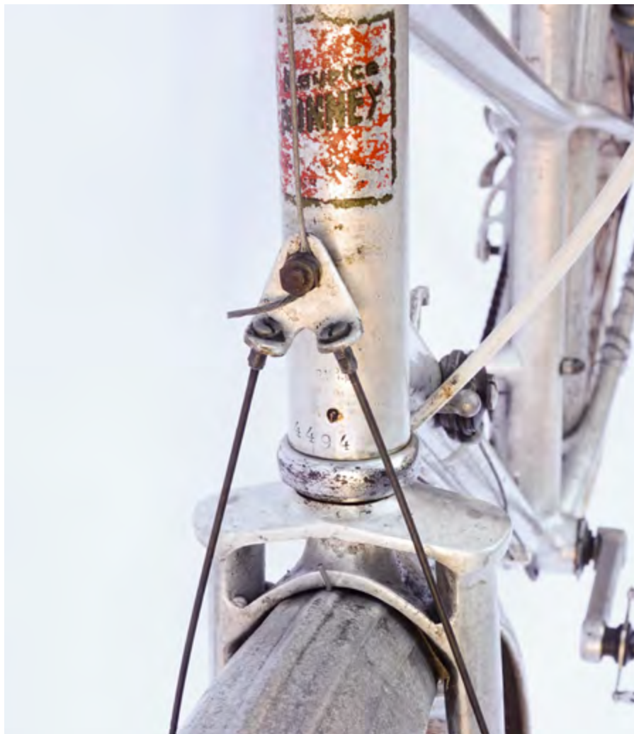
Abziehbild, Barra Stempel. Austritt des Elektrokabels über der Rahmennummer. Speichen ersetzen die Seile der Cantileverbremse.
