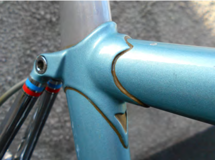
Rennrad aus den 1980er-Jahren aus aerodynamischen Rohren und Shimano Dura-Ace AX Gruppe, Sitzmuffe des Aero-Renners
