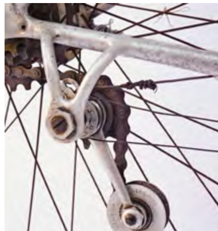
Die Kettenspannungsfeder ist über einen Seilzug durch das Röhrchen in den Hinterbau verlegt.
