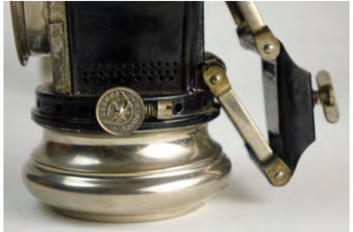
Die kleine Schraube dient zur Fixierung des Stellrads und soll dessen Verstellen verhindern
