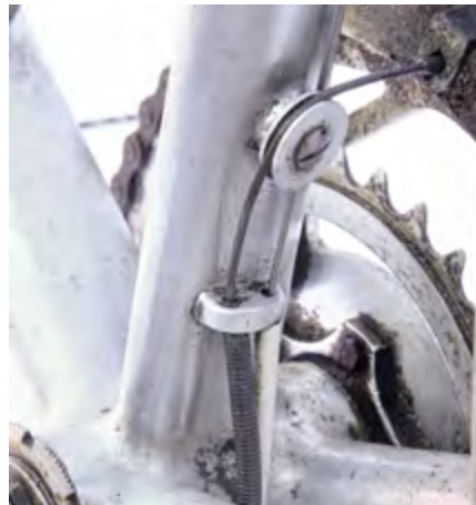
Zugkabelführung des Umwerfers über die Umlenkrolle mit „Anlötsöckel“
