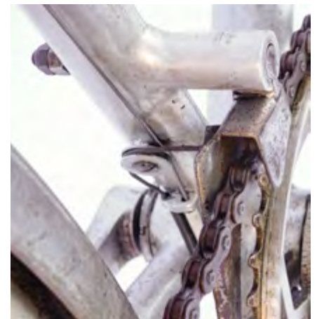
Umwerfer mit Rückholfeder im Rahmenausleger und Rollenlenkung des Zugkabels
