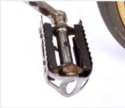
Pedalhülse aus einem Stück gedreht. Die Flügel sind teilweise abgebrochen
