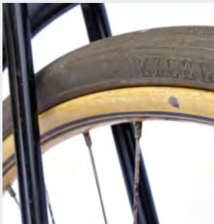
Excelsior Bereifung und gedrückte Hinterbaustreben
