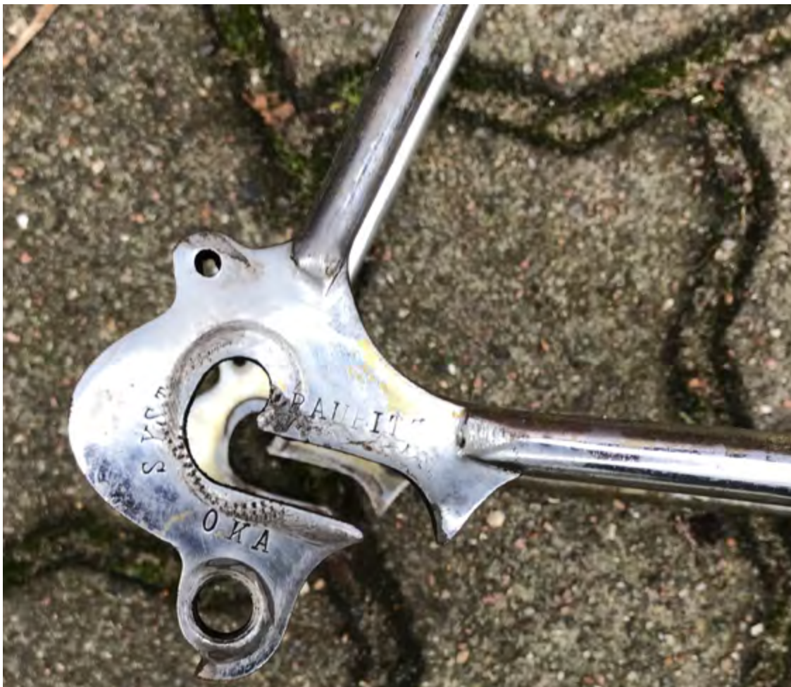
Das mit OKA System Paupitz markierte Ausfallende
