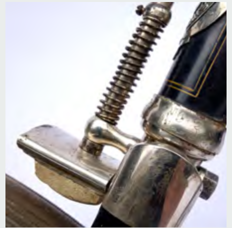
Markentypisch: Modellnummer auf dem Steuersatz, Abstandshülse über dem Bremschuh
