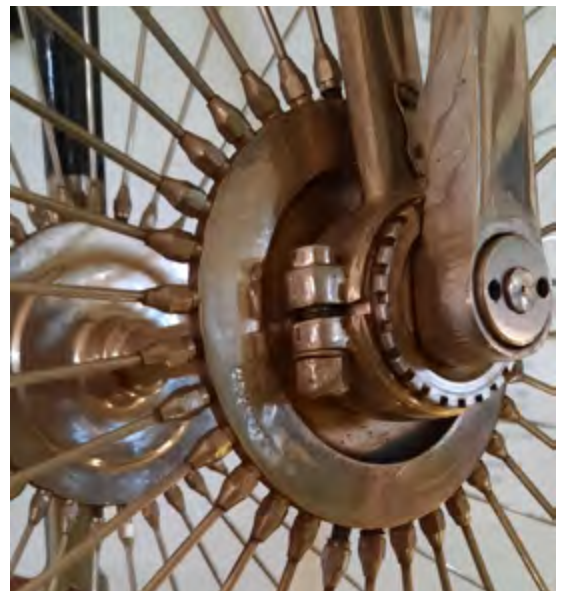
Nabe eines Hochrades mit zusätzlichen Verbindungsstücken zwischen Speichen und Nabenflansch
