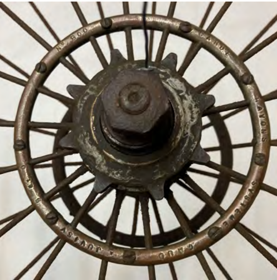
Gereinigte Außenseite des rechten Speichenschutzrings mit Inschrift GARDE RAYONS SYSTEME GAUD JUVISY S. ET O. No 800
