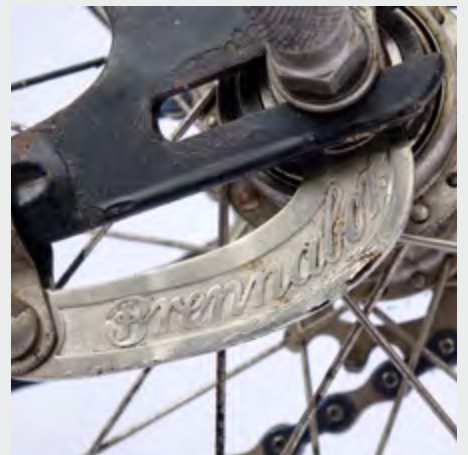
Zeittypisch: Firmenschriftzug auf dem Bremsanker der ungemarkten Torpedo Rücktrittnabe
