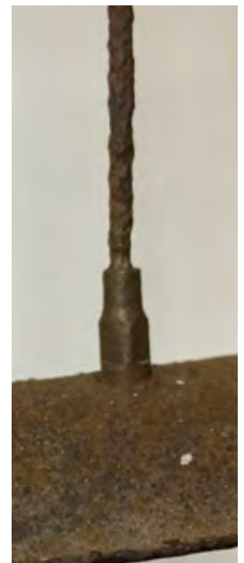
Ausschnitt der gereinigten Außenseite des rechten Speichenschutzrings mit ersetzter Speiche und Befestigung der ersetzten Speiche in der Felge mittels Speichennippel
