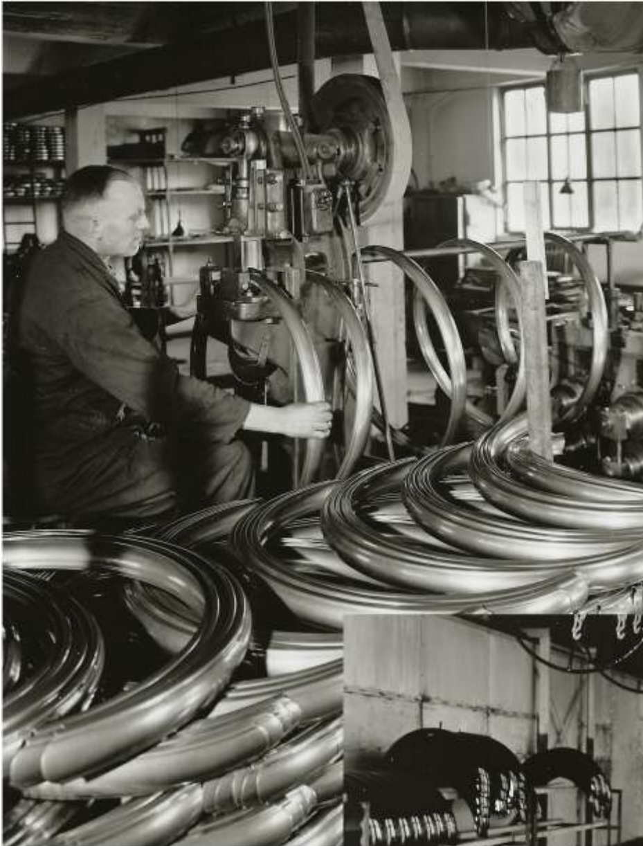
Das Foto oben zeigt die Herstellung der Schutzbleche. Von einer bereits profilierten Blechstreifenwendel werden mit Hilfe eines Schneidwerkzeugs die abgerundeten Enden des Schutzblechs erzeugt und gleichzeitig auf die passende Länge gebracht. Das Absenken der Schneide - sehr gut ist im Foto ihre Krümmung zu erkennen - wird über eine Fußsteuerung ausgelöst.
