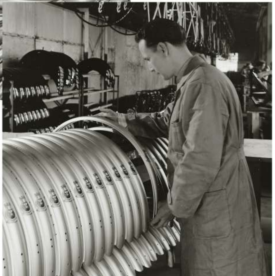
Das Foto oben zeigt die Herstellung der Schutzbleche. Von einer bereits profilierten Blechstreifenwendel werden mit Hilfe eines Schneidwerkzeugs die abgerundeten Enden des Schutzblechs erzeugt und gleichzeitig auf die passende Länge gebracht. Das Absenken der Schneide - sehr gut ist im Foto ihre Krümmung zu erkennen - wird über eine Fußsteuerung ausgelöst.
