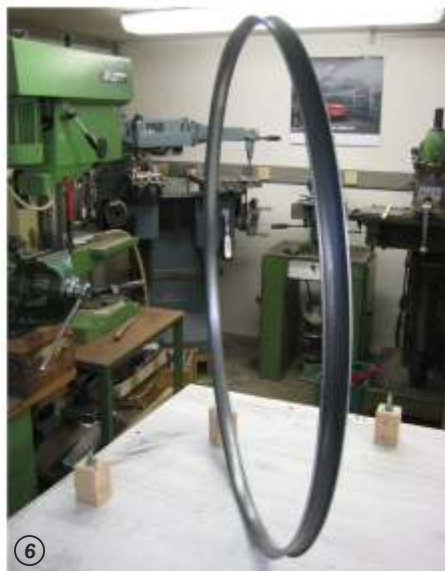
Foto 1: Drehen der Naben Foto 2: Bohren der Speichenaufnahmen Foto 3: Einspannen der Felgenrohlinge Foto 4: Absägen der Überlängen Foto 5: Halbierung des Rohres mit der Bandsäge Foto 6: Die geglättete und verrundete Felge Foto 7: Das eingespeichte Vorderrad Foto 8: In den Nabenflansch eingeschraubte Gewindenippel Foto 9: Eine nachgefertigte Tretkurbel
