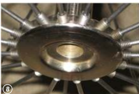
Foto 1: Drehen der Naben Foto 2: Bohren der Speichenaufnahmen Foto 3: Einspannen der Felgenrohlinge Foto 4: Absägen der Überlängen Foto 5: Halbierung des Rohres mit der Bandsäge Foto 6: Die geglättete und verrundete Felge Foto 7: Das eingespeichte Vorderrad Foto 8: In den Nabenflansch eingeschraubte Gewindenippel Foto 9: Eine nachgefertigte Tretkurbel
