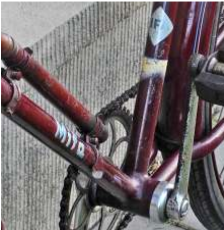
Abb. 9 Am 26“-Herren-Tourenrad von 1953 sind die geschweißten Rahmenrohre an der Tretlagerhülse zu erkennen. Die IFA-Raute am Sitzrohr wurde 1954 durch ein MIFA-Emblem ersetzt.
