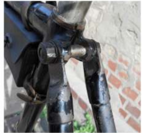
Die plumpen Sitzstrebenenden sprechen für eine Fertigung in Doos oder Eger
