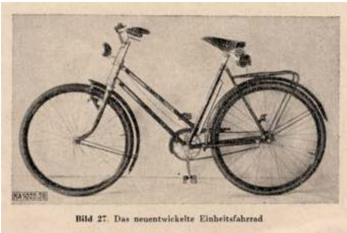
Abb. 21 Das „Einheitsrad“ von MIFA (1952), es weicht in mehreren Details vom herkömmlichen 28“-Damen-Tourenrad mit Einheitsrahmen ab.
