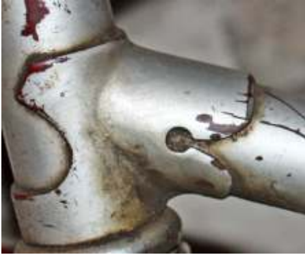
Abb. 13 Bemerkenswert ist die von anderen MIFA-Modellen abweichende Form der Rahmenmuffen an 28“-Sporträdern von 1953. Diese Muffen wurden bereits seit den 1920er Jahren an MIFA-Sporträdern verwendet. Schon 1954 wurde die Form überarbeitet bzw. vereinfacht.
