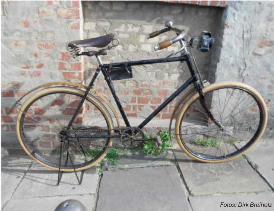
Die plumpen Sitzstrebenenden sprechen für eine Fertigung in Doos oder Eger
