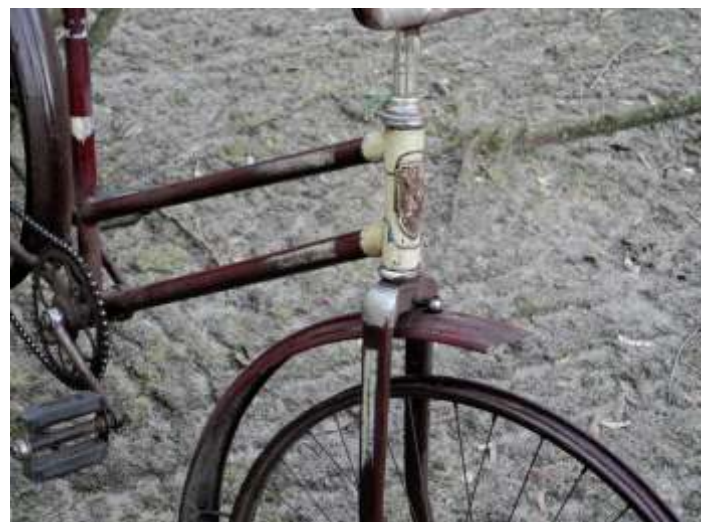
Abb. 12 Fragment eines 26“-Damen-Tourenrads (Modell S 10) von 1953: Im Gegensatz zum späteren Modell S 10 besitzt es ein gerades Ober- und Unterrohr.
