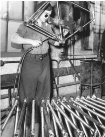
Abb. 8 Die Tretlagerhülse wurde bei MIFA-Tourenrädern bis mindestens 1953 verschweißt; auch die Hinterbaustege wurden eingeschweißt.
