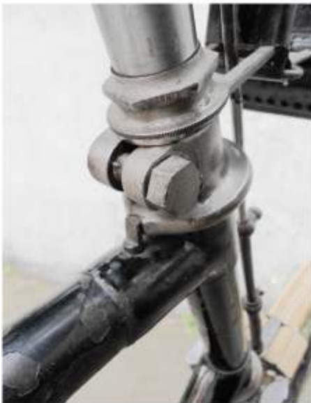
Der Lenkerfeststeller in geschlossener und offener Stellung
