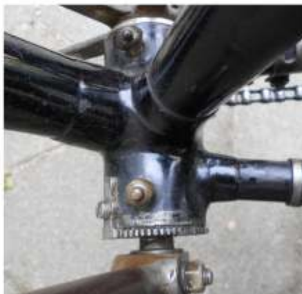
Das Tretlager mit Einstellmöglichkeit
