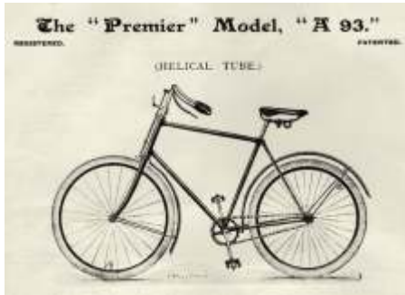
Abb. 7 Ein Premier-Herrenrad von 1893 noch mit linksseitigem Kurbelantrieb
