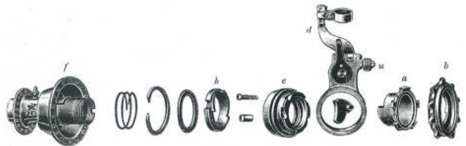
Abb. 8 Bei dieser Variante - im Unterschied zur Bauart in der Abb. 7 - kann der Sperrzahn über einen kleinen Hebel mit einem Seilzug vom Lenker aus betätigt werden
