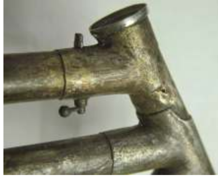
Abb. 2 Der Steuerkopf mit der Lenkerarretierung
