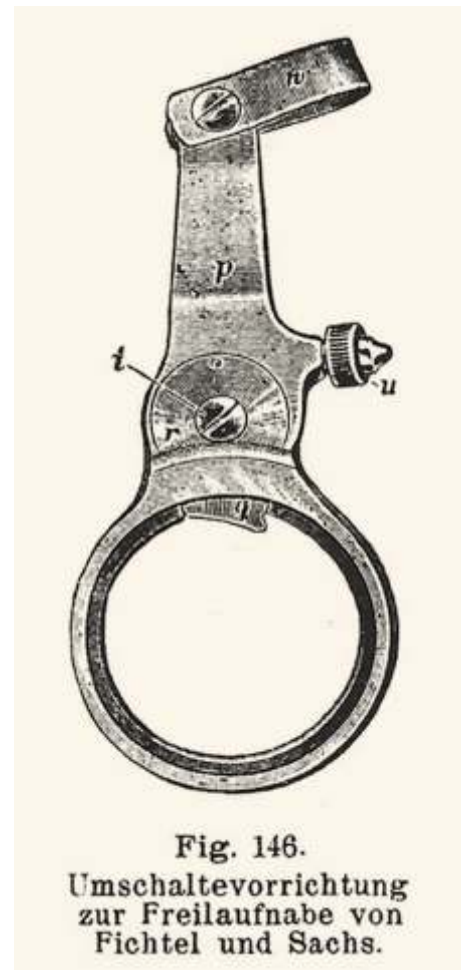
Abb. 7 Durch Drehen der Stellschraube u tritt der Sperrzahn hervor und kuppelt den Freilauf
