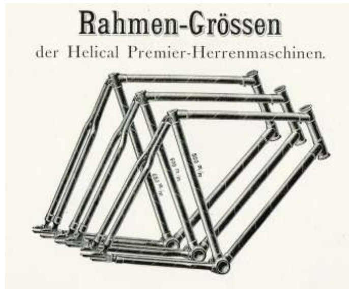
Abb. 9 Alle Rahmenrohre bestehen seit 1898 aus Rohrwendeln
