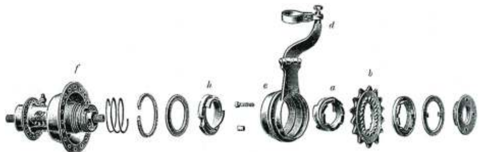
Abb. 6 Die nicht ausschaltbare Freilaufnabe von 1903 als Explosionszeichnung
