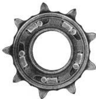
Abb. 2 Der Freilaufzahnkranz zum Aufschrauben
