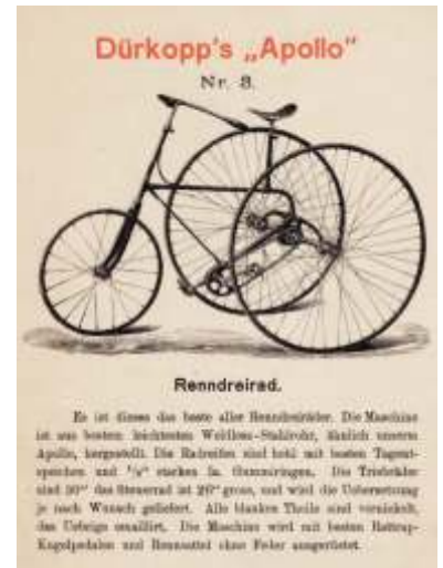
Abb. 18 Ein Dürkopp-Renndreirad - hinten 30 Zoll, vorne 26 Zoll - kostete 450 Mark.
