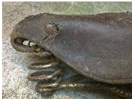
Verhärtung und Risse im Leder an einer seitlichen Niete der Sattelnase.
