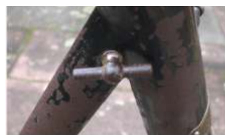
Der Knebel drückt – anders als bei Bandfeststellern – beim Feststellen mit einem kleinen Schuh auf das Gabelrohr. Der Kettenkasten ist nicht original, beim preiswerteren Nero wurde auf Zelluloidfenster verzichtet.
