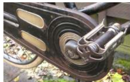
Der Knebel drückt – anders als bei Bandfeststellern – beim Feststellen mit einem kleinen Schuh auf das Gabelrohr. Der Kettenkasten ist nicht original, beim preiswerteren Nero wurde auf Zelluloidfenster verzichtet.
