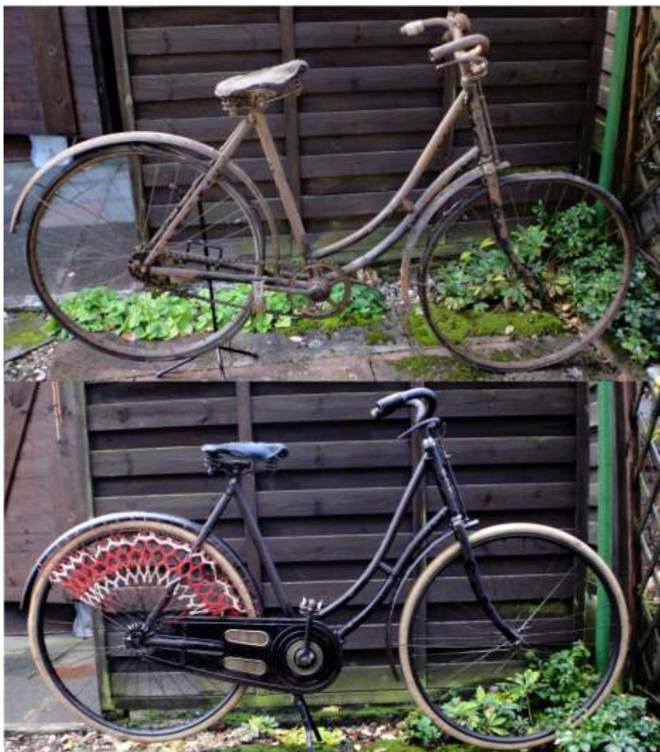
Ersetzt bzw. hinzugefügt wurden Kettenschutz, Griffe und Rocknetz aus Altbestand. Die Reifen mussten ausgetauscht werden, weil der hintere so hart und verformt war, dass er im Rahmen stecken blieb.
