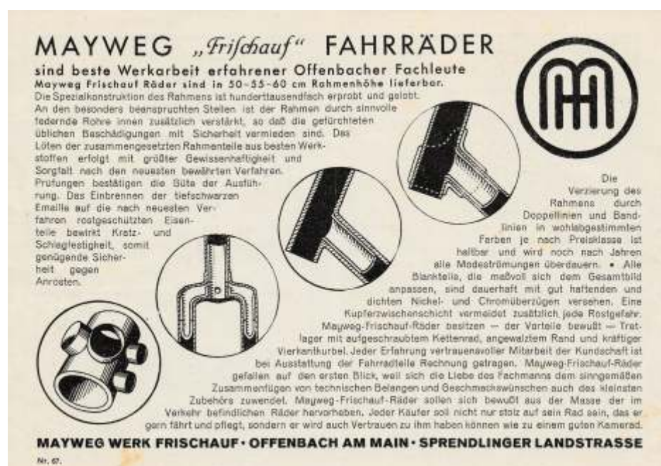
Abb. 10 Ein Werbeblatt von 1937 erläutert die hohen Qualitätsmerkmale des „Frisch auf“-Rahmenbaus
