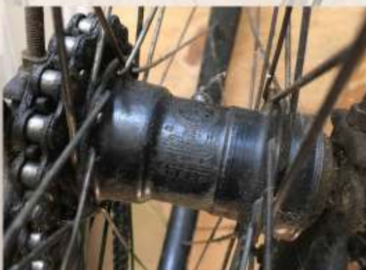
Besonders ins Auge fallen das später eingebaute Opel-Kettenblatt und die schwarze „Kriegs-Nabe“ der Marke Torpedo.
