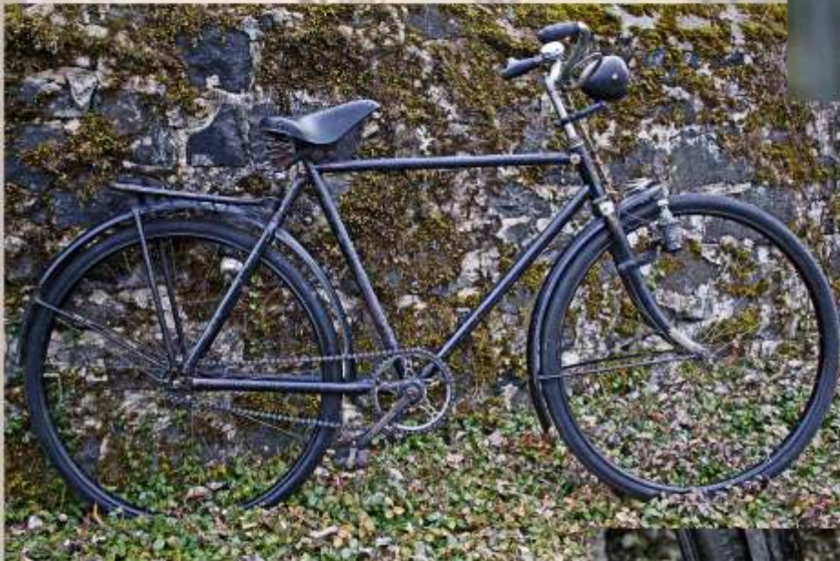
Besonders ins Auge fallen das später eingebaute Opel-Kettenblatt und die schwarze „Kriegs-Nabe“ der Marke Torpedo.
