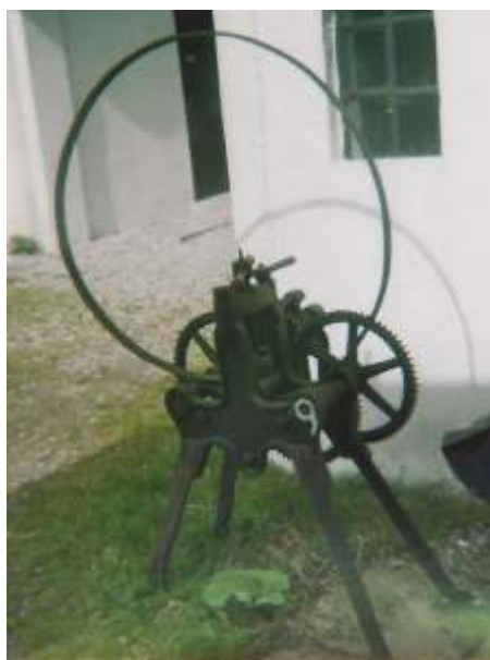
Das Foto zeigt eine Biegemaschine aus dem Museum Katharinenhof in Burg auf Fehmarn. Damit wurden eiserne Beschläge für Holzräder und Dauben für Fässer geformt. (eingesandt von Peter Raskob, Mechnich)
