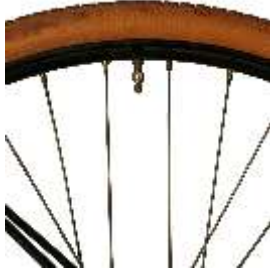
Abb.6 So wollte es Käuderer bei den eingespeichten Laufrädern seiner Lehrlinge sehen: größtmöglicher Platz für das Ventil, damit die Speichen beim Aufpumpen nicht im Weg sind
