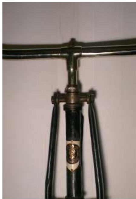
Abb. 16 Steuerkopf mit den angesetzten Verstärkungen der Gabel
