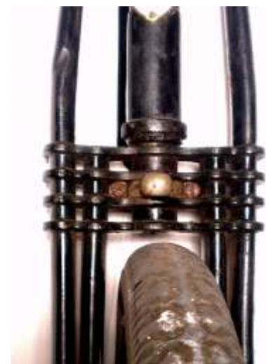
Abb. 18 Der Vier-Platten-Gabelkopf in äußerst stabiler Doppelbauweise
