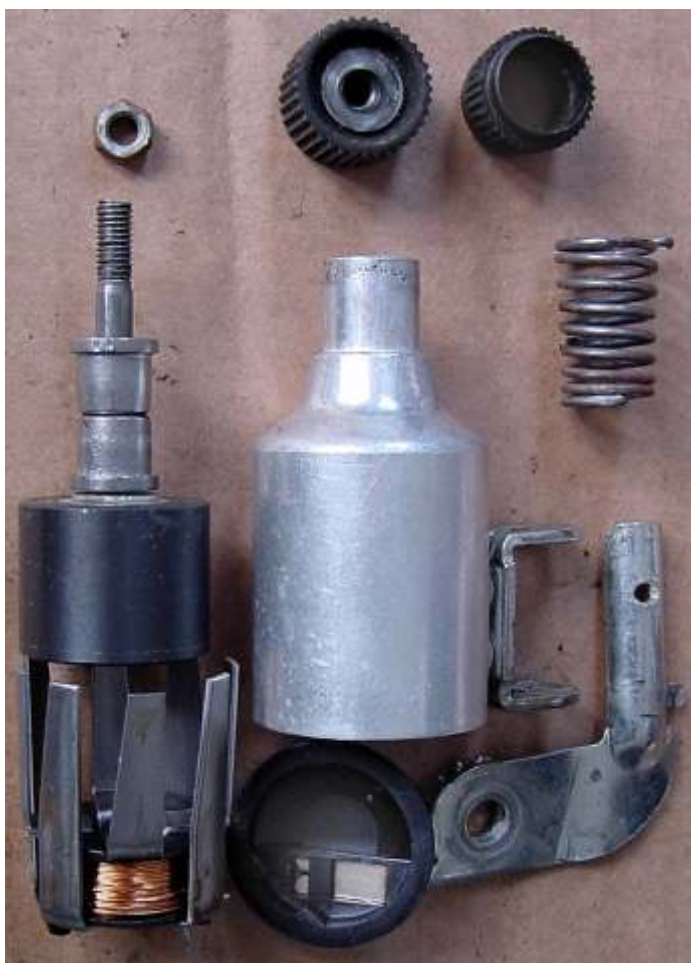
Abb. 4: Typischer Klauenpoldynamo mit rotierendem achtpoligem Polrad aus keramischem Magnetmaterial.
