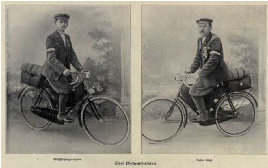
Abb. 3: „Zwei Weltwanderfahrer“ - Willy Schwiegershausen (links) und Gustav Kögel, aufgenommen in einem Fotoatelier. Besonderes Baumerkmal der Räder sind die Lenker, die sowohl eine aufrechte als auch vorgebeugte Haltung erlauben.
