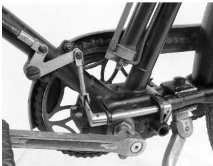
Abb. 2 Rappa-Tretlager mit mehrteiligem Schaltgestänge. Foto: F. Heinze
