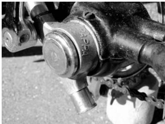
Abb. 8 und 9 Wittler-Herrenrad mit einer späteren, modifizierten Rappa-Tretlagerschaltung. Man erkennt die Schaltgestänge-Verlängerung durch einen gekröpften Flachstahl und die Hülse unter dem Tretlagerbereich. Fotos auf dieser Seite: D. Bartholdi
