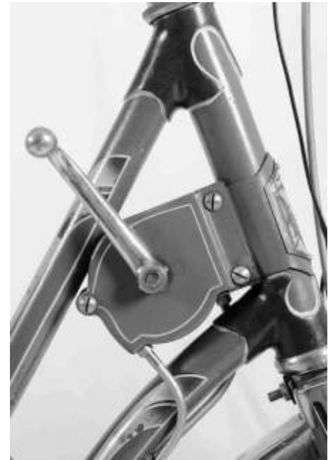
Abb. 5 Schaltbox am Gabelkopf eines Damenrads (spätere Seilzugausführung).
