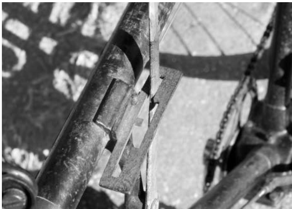
Abb. 10 Rappa 4-Gang-Schaltkulis am Oberrohr.
