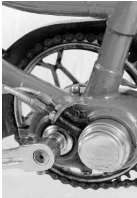
Abb. 4 Blick auf den im Tretlagerbereich fein einstellbaren doppelten Bowdenzug, mit dem die Rappa-Schaltung exakt betätigt wurde.
