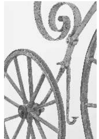
Starleys CMC Coventry Modell vom Frühjahr 1870. Man beachte die schön geschwungene C-Feder. Die hintere Gabel verläuft nur einseitig. Das Velociped steht in der Glynn Stockdale Collection.
