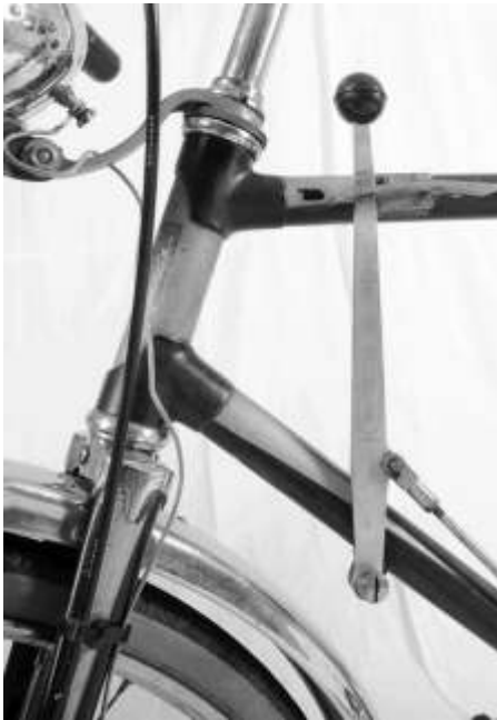
Abb. 3 Solide Einheit: Ein auf der linken Fahrradseite angebrachter Rappa-Schalthebel mit Kulisenföhrung und angelenktem Gestänge.
