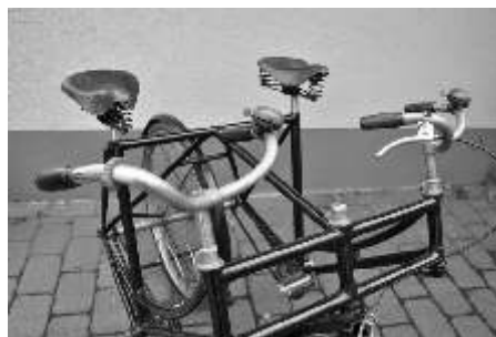
Foto ganz oben: Frank Winkler mit seinem Sociable. Darunter: Frontansicht mit doppelter Steuerung (links) und verlängerte Hinterradachse für die Kettenaufnahme auf beiden Seiten. Ganz links: Vater und Sohn in Aktion. Fotos: Familie Winkler
