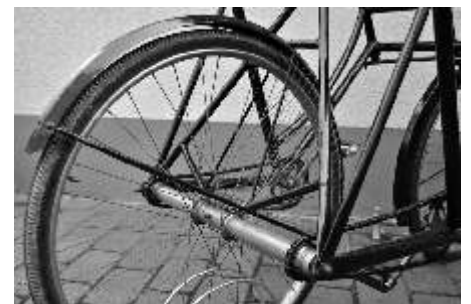
Foto ganz oben: Frank Winkler mit seinem Sociable. Darunter: Frontansicht mit doppelter Steuerung (links) und verlängerte Hinterradachse für die Kettenaufnahme auf beiden Seiten. Ganz links: Vater und Sohn in Aktion. Fotos: Familie Winkler
