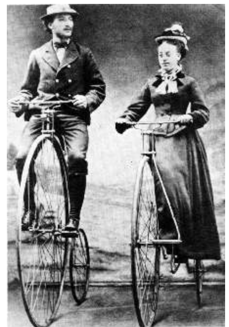
Ausfahrt auf Ariel-Rädern um 1872. Das Lady-Bicycle ist asymmetrisch gebaut, damit die Fahrerin im Damenreitsitz fahren kann.
