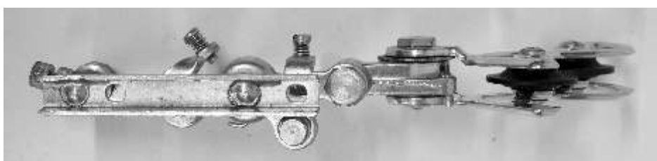
Altenburger Schaltung vom Typ 2, in der überarbeiteten Version von 1956. Oben die Schaltung mit Verpackung, darunter Ansichten von der Seite und von oben.
