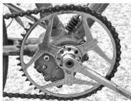
Tretlager mit drei Adlern, Hohlachse und ausgefrästen Kurbeln.
