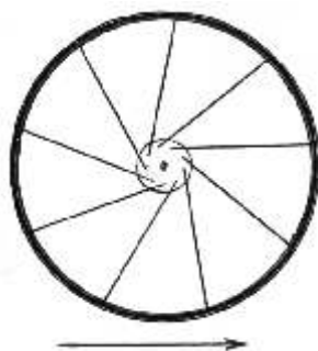
Anordnung der Speichen bei nabengebremsten Laufrädern.
