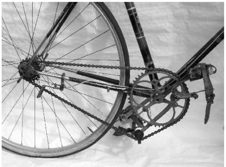
Renate Franz mit ihrem Köthke-Rennrad (oben). Die Nase des Lohmann-Sattels wird auf dem Oberrohr abgestützt (links). Die Bezeichnung „Champion“ wurde bis in die 70er Jahre für Köthke-Räder verwendet (rechts). Schmuckstück am Rad: Die Schaltung Super Champion mit Kettenspanner und Umwerfer (unten).
