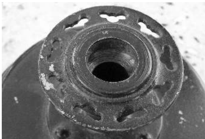
Sonderfall: Trommelbremsen mit Knopfloch-Speichenlöchern.
