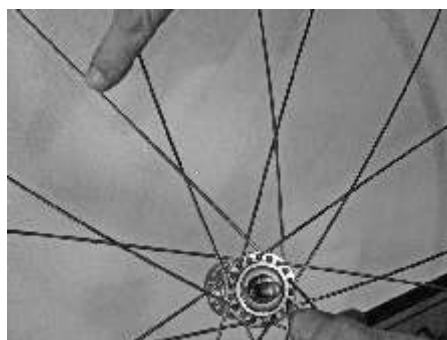
Abb. 11: Kopfspeiche kreuzt Rückenspeichen: zweimal drunter, einmal drüber.
