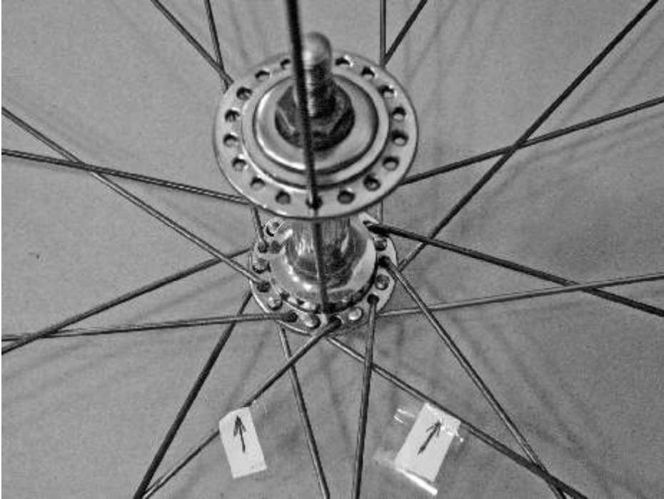
Abb. 13: Steckt man eine Speiche senkrecht durch das Loch im Flansch, landet man zwischen zwei Löchern des gegenüberliegenden Flansches.
