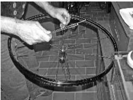
Abb. 8: Die Kopfspeichen kommen in den ersten Flansch.
