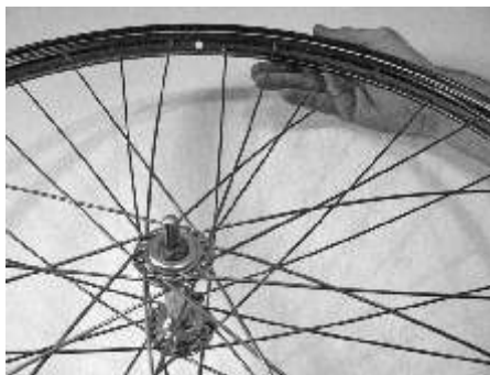
Abb. 16: Richtig eingespeicht bleibt genug Platz für die Luftpumpe am Ventil.
