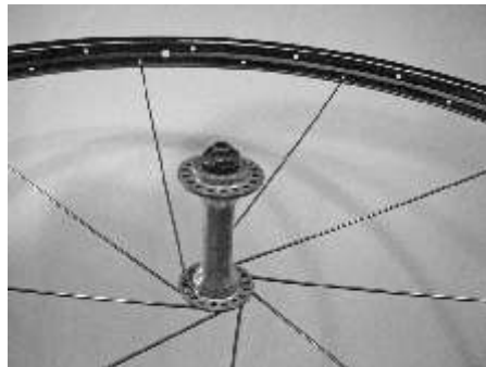
Abb. 9: Nabe so gedreht, dass die nebenliegende Speiche vom Ventil wegzeigt.
