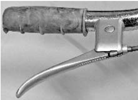
Victoria-Herrenrad um 1955, Lenker vor und nach der Restaurierung. Nach der Aufarbeitung verchromter Bauteile können Kupferfarben erscheinen. Grund: Der Aufbau einer Glanzverchromung besteht aus einer 10 µm dicken Kupfer-, einer darauf liegenden 5 µm starken Nickel- und abschließend einer 2 µm starken Chromschicht. Sind Chrom und Nickel korrodiert, bleibt nur die kupferne Schicht zurück.
