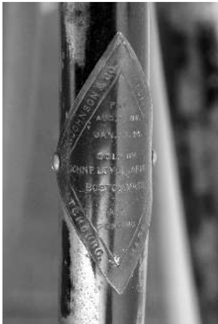
Foto oben: Der schöne Swift-Rahmen wurde von Silberbronze und schwarzem Sprühlack befreit. Darunter fanden sich immer noch Reste der originalen Lackierung.
