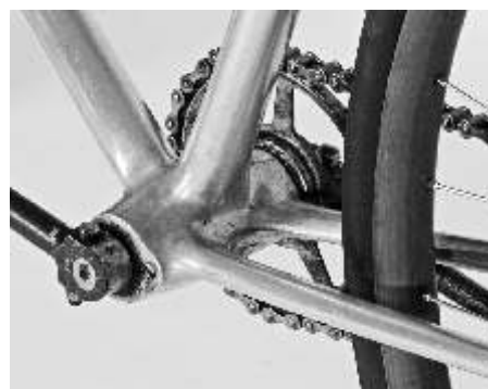
Alurahmen aus einem Stück gegossen. Tretlager gekapselt und seitwärts in den Rahmen eingeschoben.
