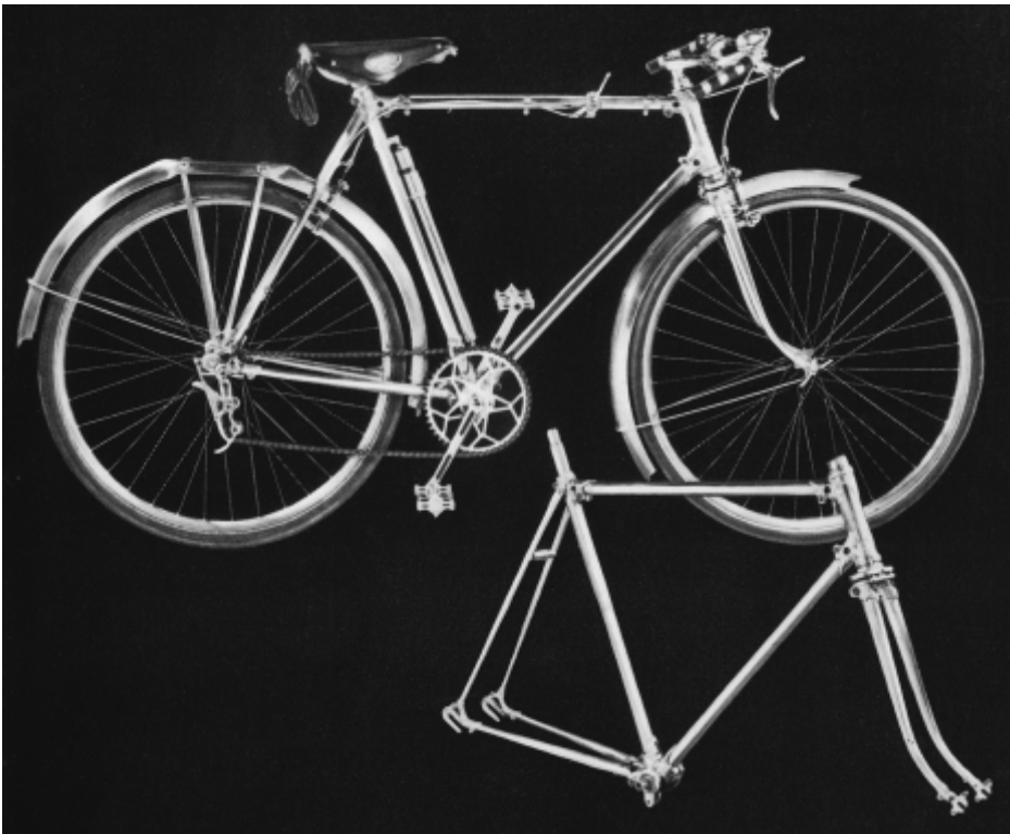
Dieses frühe Caminargent ist mit der seltenen Rectiligne-Schaltung ausgestattet, die Pierre Caminade 1935 auf den Markt brachte.
