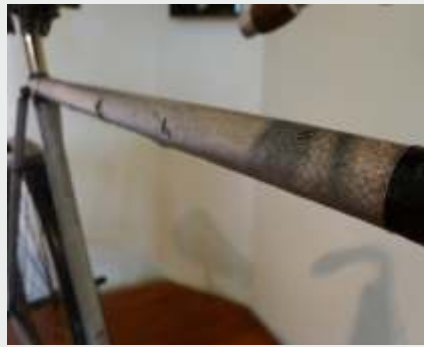
Aluminium-Schutzbekleidung eines Anker-Rades von 1896
