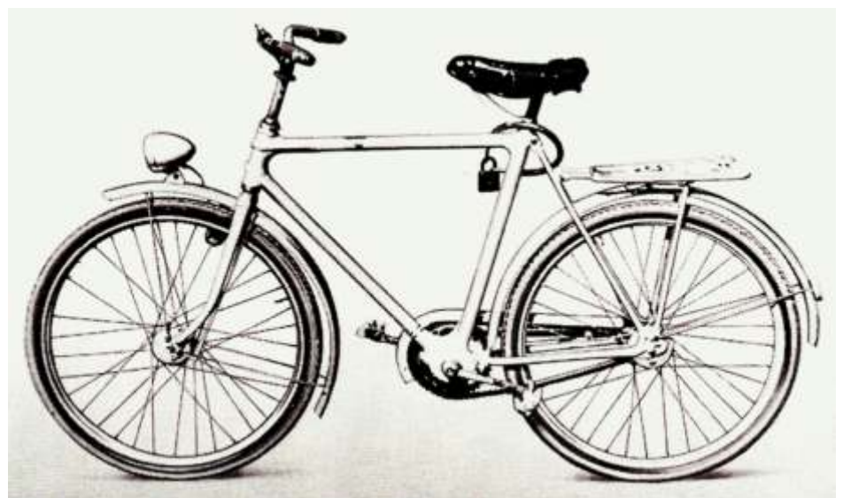
BMW-Rad aus Aluminium mit Tretlagerschaltung
