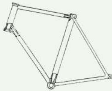
Alu-Gussrahmen mit innenverstärkten Rohrenden
